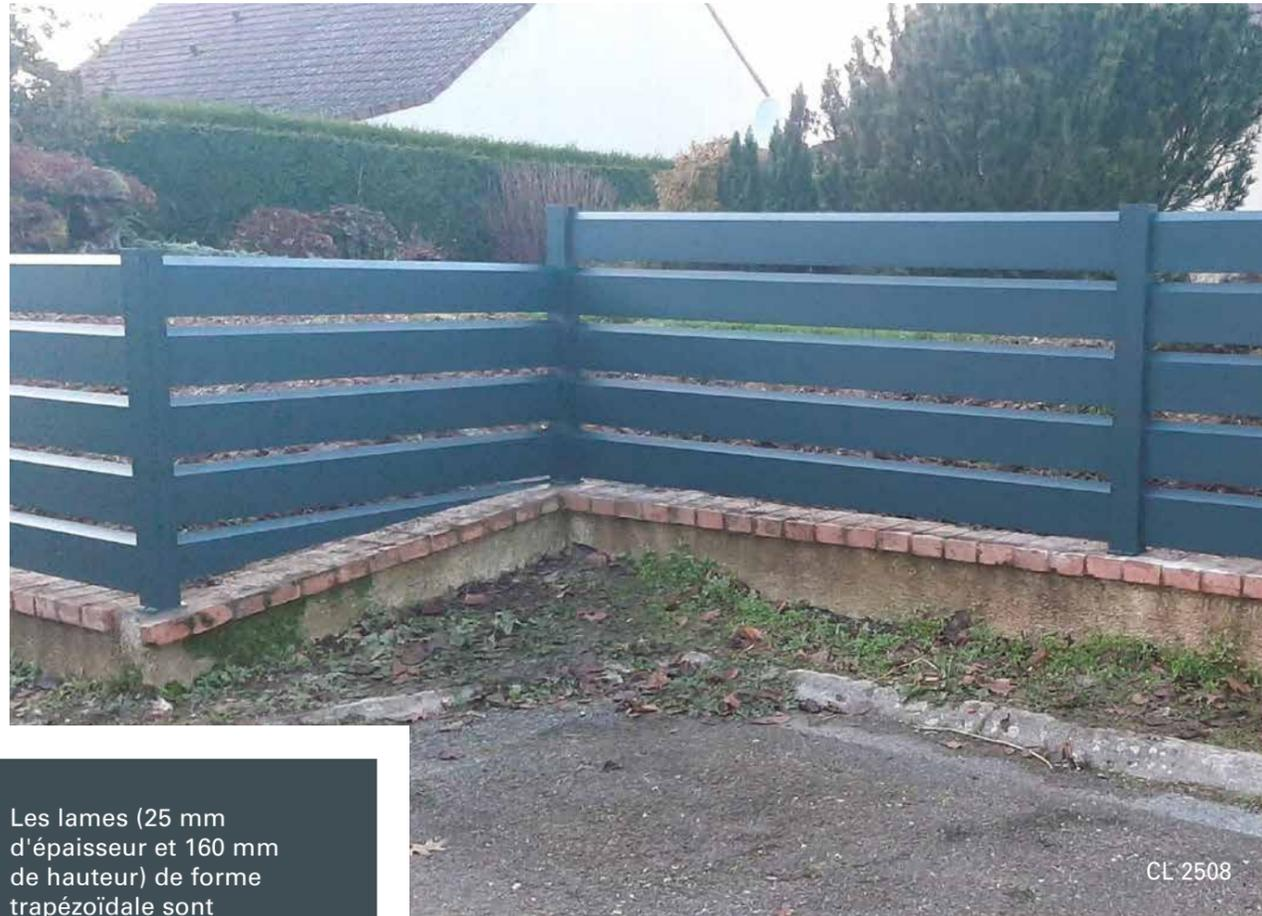
Les lames (25 mm d'épaisseur et 160 mm de hauteur) de forme trapézoïdale sont assemblées espacées de 50 mm l'une à l'autre pour un ajour réel visible de 25 mm et toujours sans traverses.
